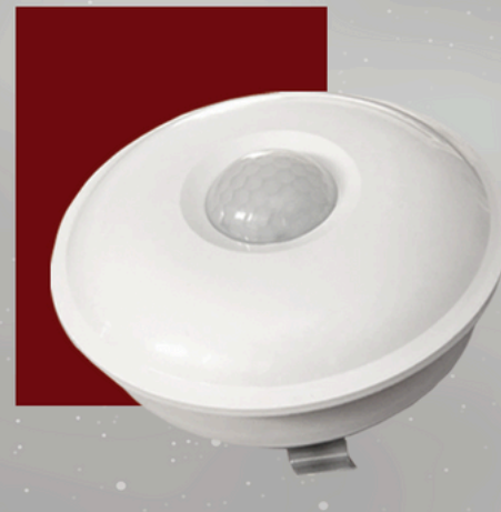
Sensor de Presença de Sobrepor com Lente de 360° Teto Bivolt - Cód. 5611 *Lâmpada incandescente 127V~ 500W - 220V~ 1000W *Lâmpada fluorescente 127V~160W - 220V~ 320W Sobrepor e Embutir *Indicado o uso de 2 produtos em corredores longos.
